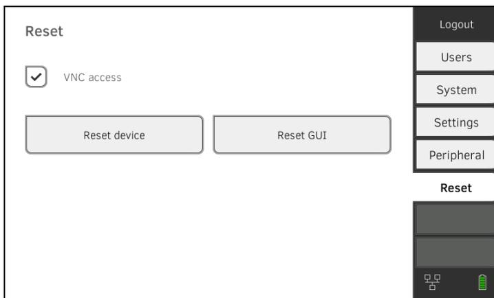
2. Tippen Sie die Taste **Reset GUI (GUI zurücksetzen)** an.
