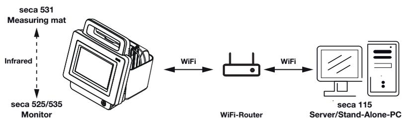
Wenn Sie das Gerät als WiFi-Client mit Ihrem Netzwerk verbinden, kann die Messmatte -falls vorhanden- ausschließlich über die Infrarotschnittstelle mit dem Monitor kommunizieren.
