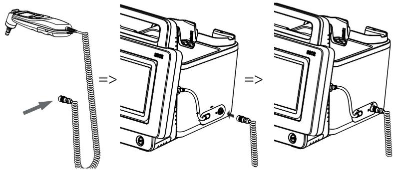
1. Stecken Sie die Anschlussstecker des Ohrthermometers in die Buchse am SmartBucket, bis der Anschlussstecker spürbar einrastet.
