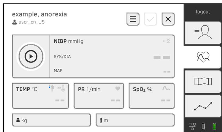
Sie können in einem Messvorgang einzelne oder mehrere Vitalparameter messen. Die Messung startet automatisch nach Applikation des Messzubehörs am Patienten (Ausnahme: Blutdruckmessung und Temperaturmessung im Ohr). Die Pulsfrequenz wird je nach Gerätekonfiguration über die Sauerstoffsättigung oder den Blutdruck ermittelt.
