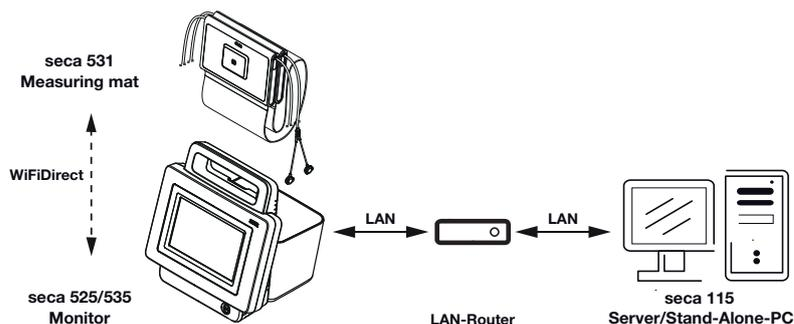
Wenn Sie das Gerät via LAN-Kabel mit Ihrem Netzwerk verbinden, kann die Messmatte -falls vorhanden- über die werkseitig aktivierte **WiFi direct (WiFi direkt)**-Verbindung mit dem Monitor kommunizieren. So können Daten auch dann ausgetauscht werden, wenn die Messmatte nicht in die Magnethalterung des Monitors eingehängt ist.
